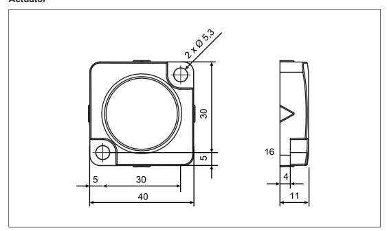
Fig.: Actuator PSEN cs1.1
