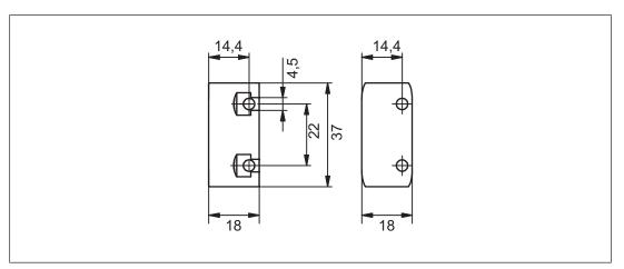
Fig.: Actuator PSEN cs3.1
